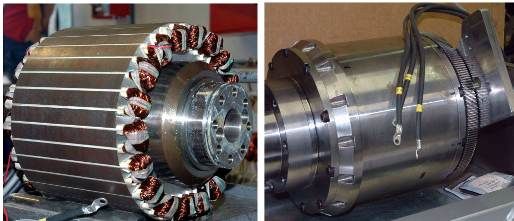
Obr. 5.26 Prototyp 34-pólového motoru
