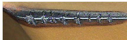
Tepelné trhliny na břitě
