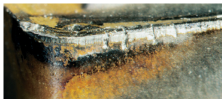
Typické způsoby opotřebení břitové destičky
