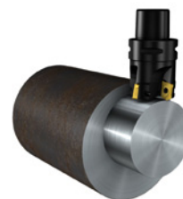
Rotační frézování
