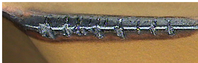
Tepelné trhliny v důsledku použití řezné kapaliny
