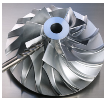
Jedním z příkladů frézování uzavřených rohů jsou oběžná kola turbín.
