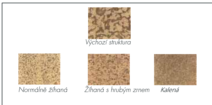
Obr. 1.7 Obrázky struktury oceli C60, různě tepelně zpracované
