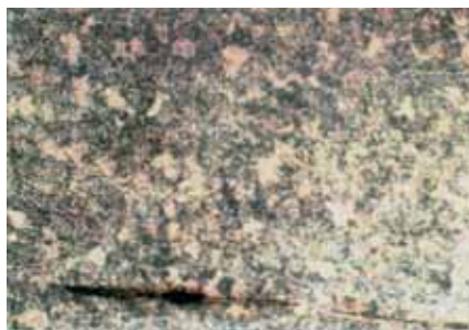
Obr. 1.6 Mangansulfidové inkluze
