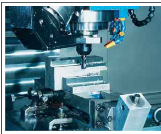
Obr. 8.2 Čelní obvodové rovinné frézování
