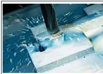
Obr. 3.11 Korunkový vrták s vložkou
