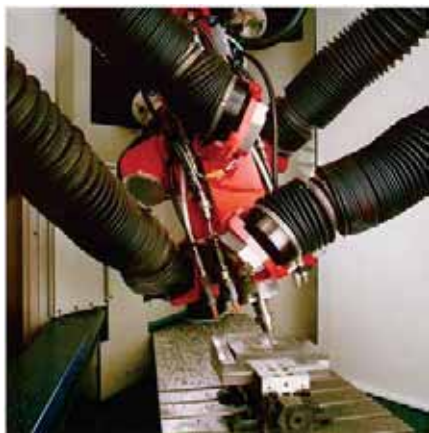
5-osé simultánní frézování na hexapodu
