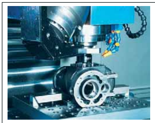
Obr. 8.1 Frézování převodové skříně
