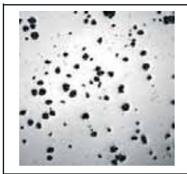
Obr. 1.12 Vzhled struktury GGG 40
