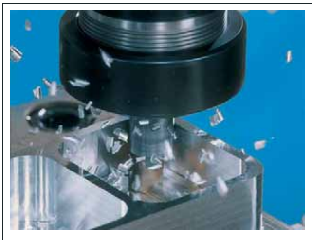
Obr. 1.14 Ponorné frézování do hliníku
