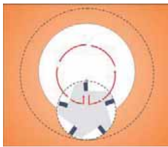
Obr. 8.13 Radiální zanořování (snížte posuv!)
