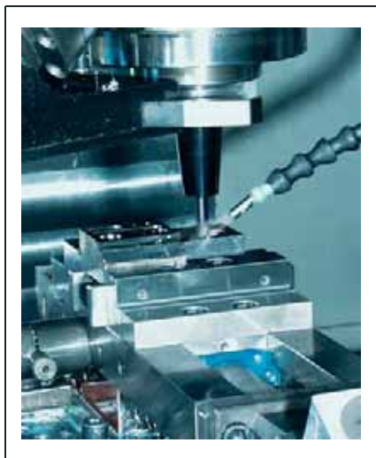
Obr. 2.34 Použití minimálního mazání
