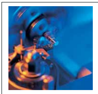
Obr. 9.3 Soustružení tvrdých materiálů
