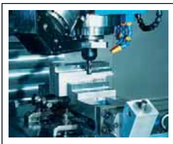
Obr. 1.8 Frézy z oceli k zušlechťení
