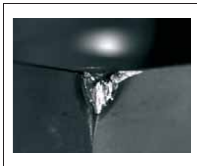
Obr. 2.14 Vyštípnutí ostří
