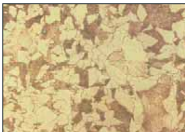
Obr. 1.4 Ferritově-perlitová struktura (ferrit je světlý)
