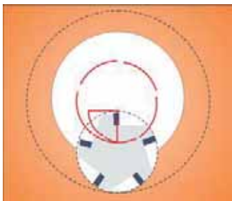
Obr. 8.12 Přisuv v zanořovací křivce (doporučená metoda)
