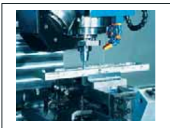
Obr. 1.17 Frézování titanu
