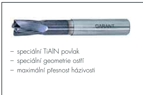
Obr. 2.29 Fréza GARANT-TK-Torus pro vysokorychlostní obrábění ( v_c do 1000 m/min)
