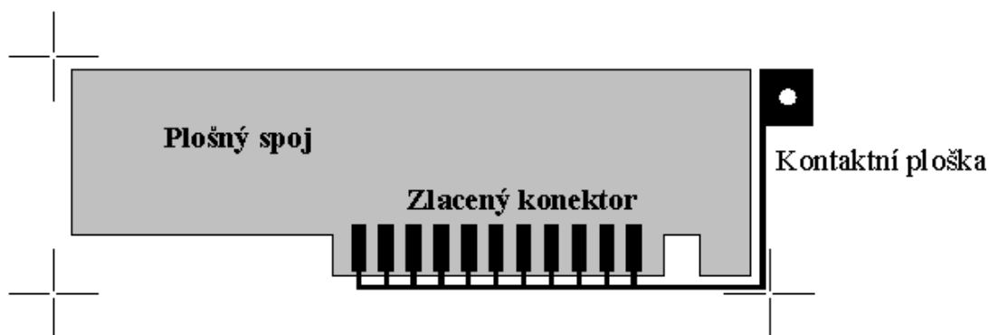
Obr. 5: Propojení pro galvanické pokovování
