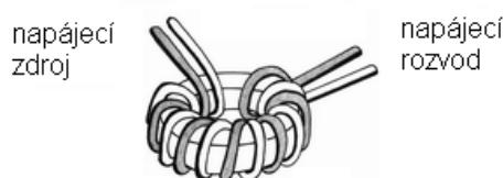
Obr. 3.19: Bifilárně vinutá tlumivka
