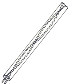
Obr. 2.12: Kroucený dvojvodič zapuštěný do izolantu
