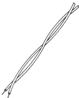
Obr. 2.11: Kroucený dvojítý vodič bez stínění
