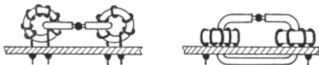
Obr. 4.13: Provedení impulsních transformátorů
