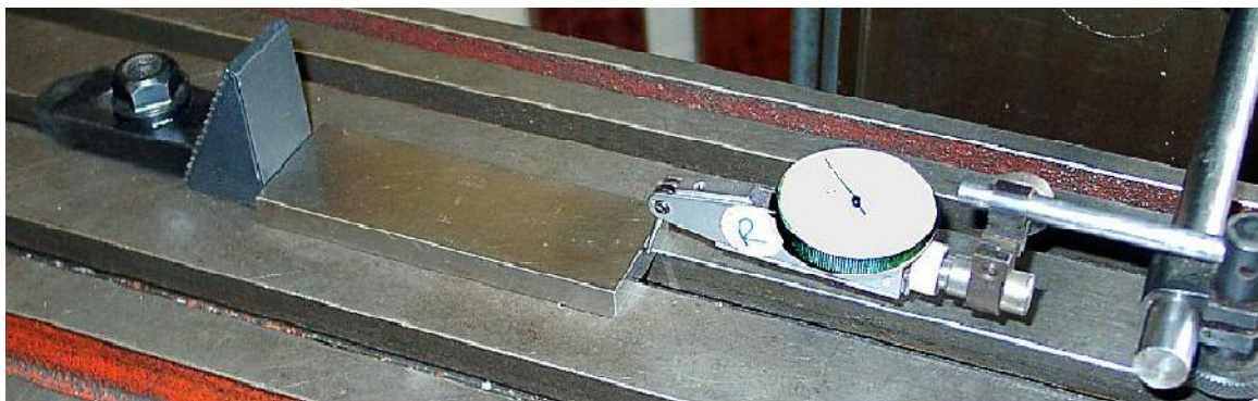
Obrázek 5.14 – Ustavená 4" měrka
