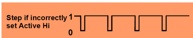
Obrázek 4.5 – Špatně konfigurovaný výstup modifikuje signál
