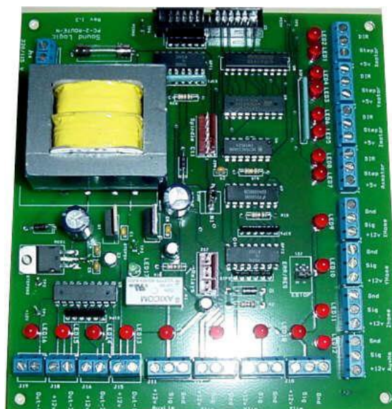
Obrázek 4.2 – Tři příklady komerčních oddělovacích desek
