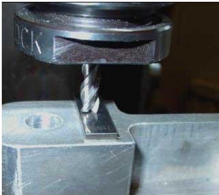
7.10. Obrázok. Posun osi Z stanovaný pomocou merítka
