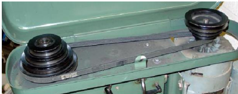
Obrázek 5.15 – Vřeteno s řemenovými převody - Pulleys
