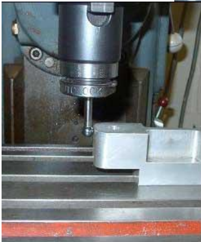
7.11. Obrázok. Zameranie kontúry v osi X
