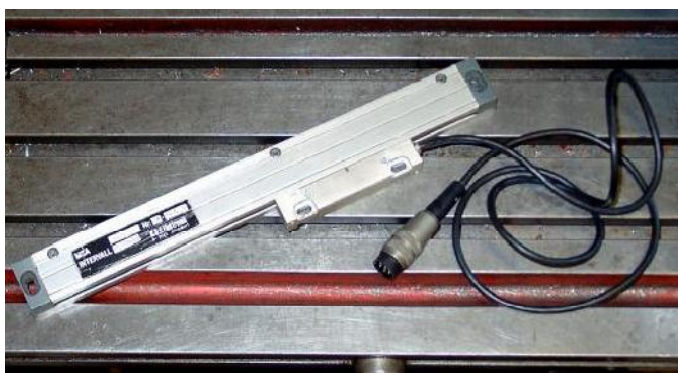
Obrázek 4.15 – Lineární enkoder připraven na montáž
