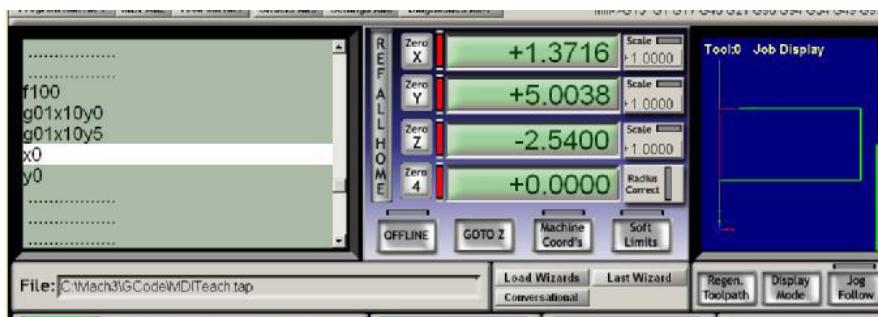
Obrázek 3.7 – „Naučený“ part program „běží“ ...
