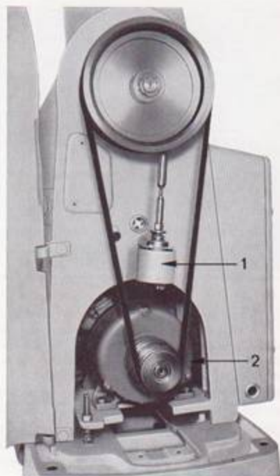
1. Elektro-magnetisk bremse. - 2. 4 HK hovedmotor
