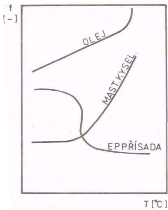
Obr. 5 Vliv řezného prostředí na výsledky obrábění
