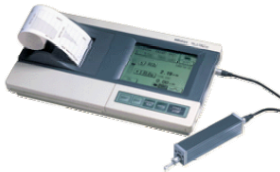
Obr. 7. Měřič drsnosti povrchu Mitutoyo SJ-301
