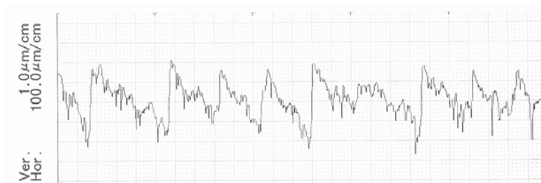
Obr. 14. Profil drsnosti povrchu vzorku č.7
