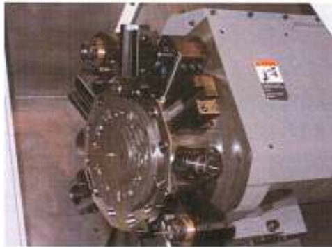
Obr. 2 Typická revolverová hlava sústružníckeho centra
