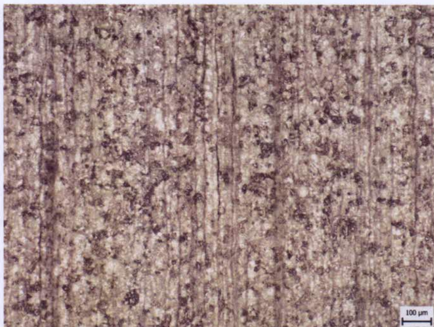
Obr. 12 Protvářená základná mikrostruktura vzorku 1u
