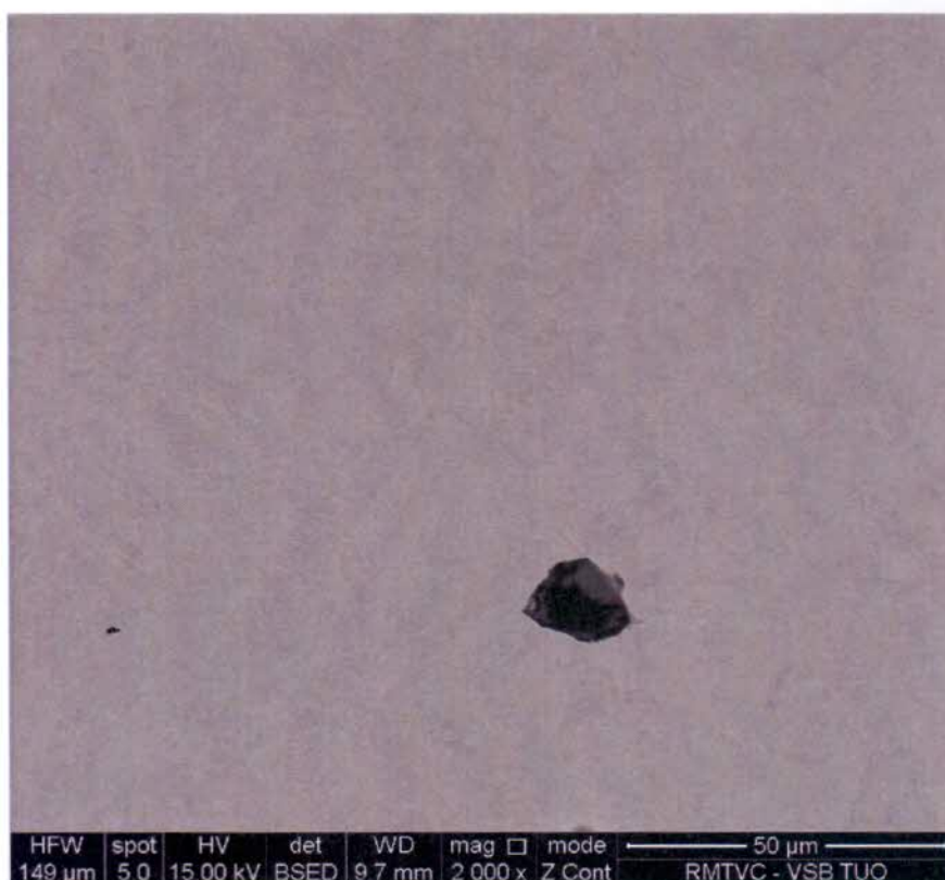
Obr. 27 Komplexní nekovový vměstek DS, oxidické jádro + sulfidická obálka, vzorek 5u
