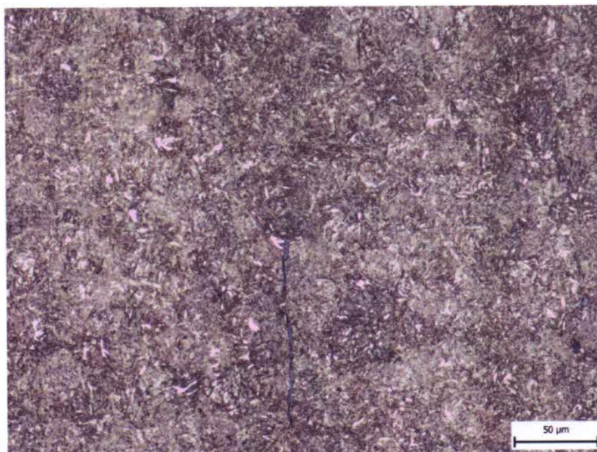
Obr. 21 Základná mikrostruktúra s nevýraznými mikrosegregačnými pásmi, vzorek 3u
