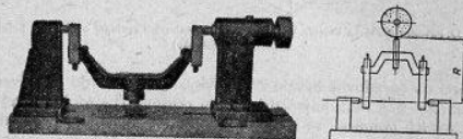
Obr. 54. Přístroj pro tvarování brusných kotoučů
