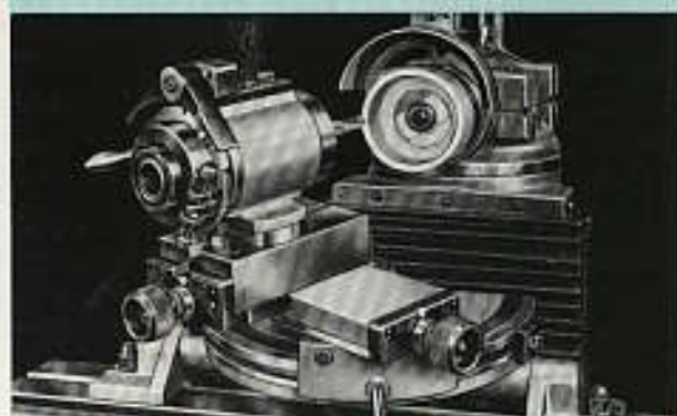
Abb. 95, Schleifen des Radius an einem Aufstecksenker mit der Radienschleifvorrichtung Nr. 3.57
