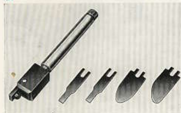
Abb. 109, Einzelteile des Stützfingers mit Feinstellschraube
