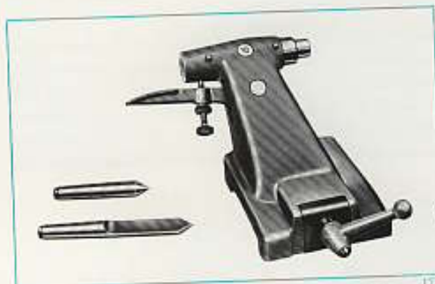
Abb. 112. Linker Reitstock mit einer kurzen und einer langen Körnerspitze.
