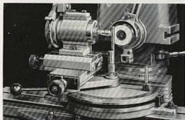
Abb. 88, Einstellen des zu schleifenden Radius entsprechend Abb. 87-92
