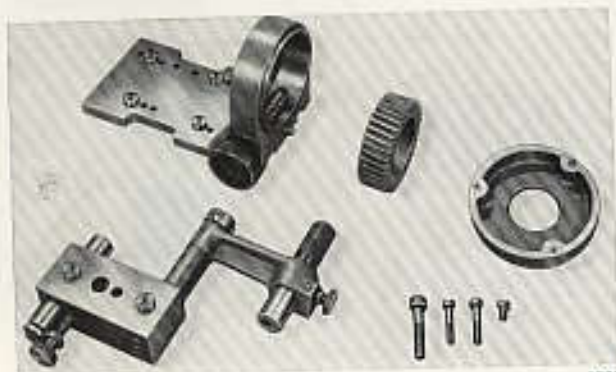
Abb. 140, Einzelteile der Schleifvorrichtung Nr. 0.88 für Rundformmeißel
