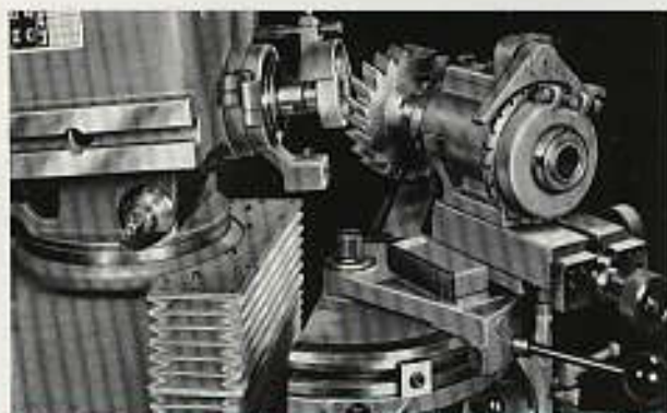
Abb. 93, Schleifen des Radius an einem Walzenstirnfräser mit der Radienschleifvorrichtung Nr. 1.57
