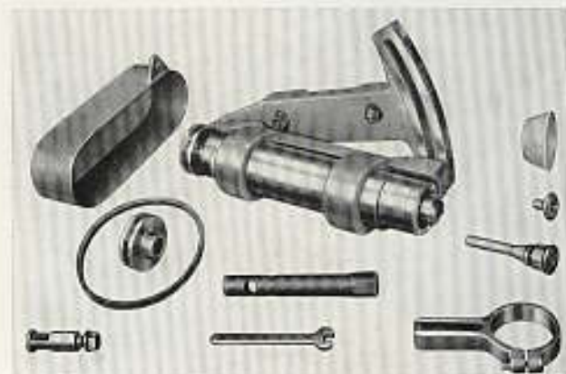
Abb. 81, Einzelteile der schrägstellbaren Hilfsschleifspindel
