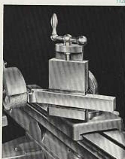
Abb. 36, Schraubstock Nr. 0.18 an Winkelstück Nr. 0.21 auf Unterteil Nr. 0.20
