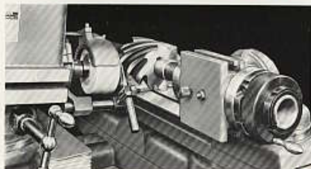
Abb. 2, Schleifen der Freifläche an einem drolligen Walzenfräser 1043
