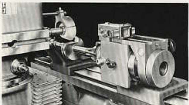
Abb. 4, Schleifen der Spanfläche an einem Rundformmeißel mit Sonderzubehör „Schleifvorrichtung Nr. 0,88 für Rundformmeißel“ 1246
