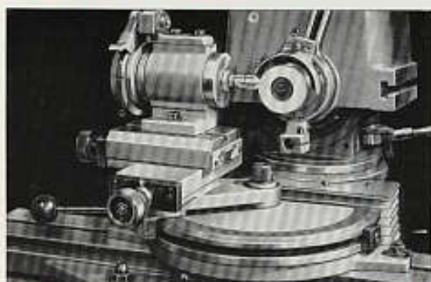
Abb. 87, Schleifen der Freifläche an einem Gesenkräuser mit der Radienschleifvorrichtung Nr. 1.57
