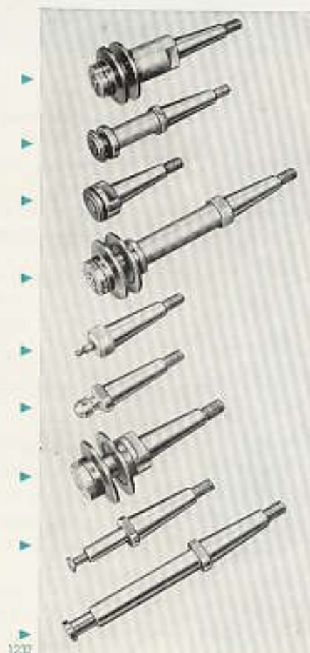
Abb. 10. Schleifkörperaufnahmedorne
