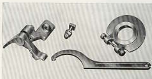
Abb. 40. Böckchen mit Teilhebel, Befestigungsschraube, Teilscheibenflansch, Bedienungsschlüssel
