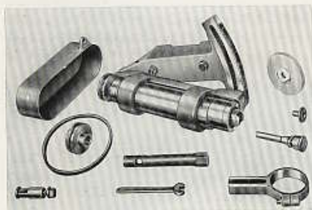
Abb. 84, Einzelteile der schrägstellbaren Hilfsschleifspindel mit erhöhter Grundplatte
