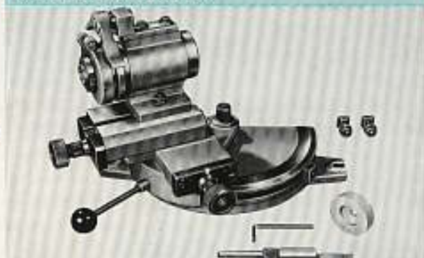
Abb. 94, Einzelteile der Radienschleifvorrichtung Nr. 1.57 mit Zubehör
