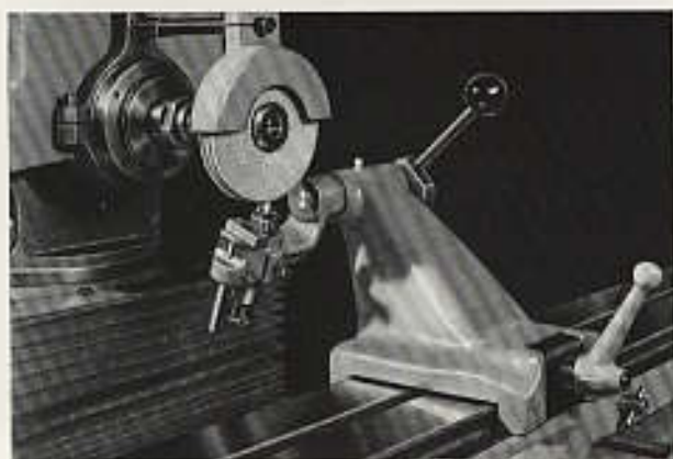
Abb. 115, Abrichten einer Schleifscheibe mit der Radienabrichte Nr. 0.74
