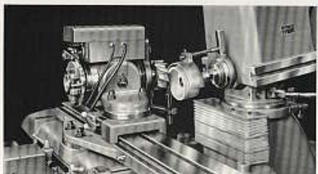
Abb. 4a, Schleifen der Freifläche an der Stirnseite eines Walzenstirnfäders mit der selbsttätigen Teilvorrichtung Nr. 0,29 1753
