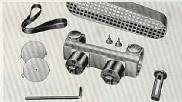
Abb. 79, Schleifspindelhalter mit Erhöhungsstücken, Antriebsriemen und Riemenschutzhaube, Abdeckscheiben, Befestigungsschrauben, Bedienungsschlüssel und Schutzhaubenhalter
