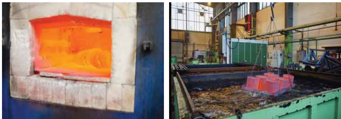
Obr. 2.17. Ohrev súčiastky na kaliacu teplotu a jej ďalšie ochladenie vo vodnom kúpeli
