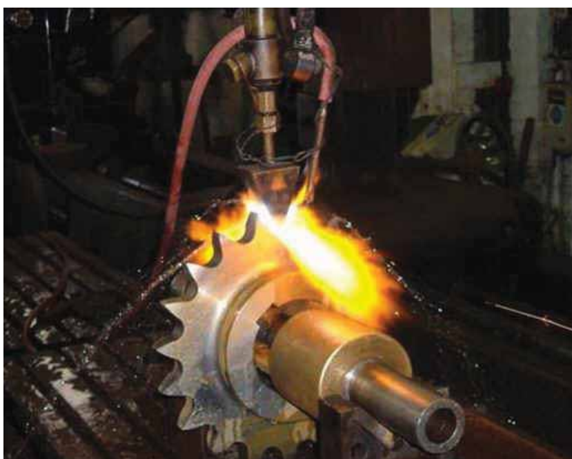
Obr. 2.22. Príklady povrchového kalenia plameňom
