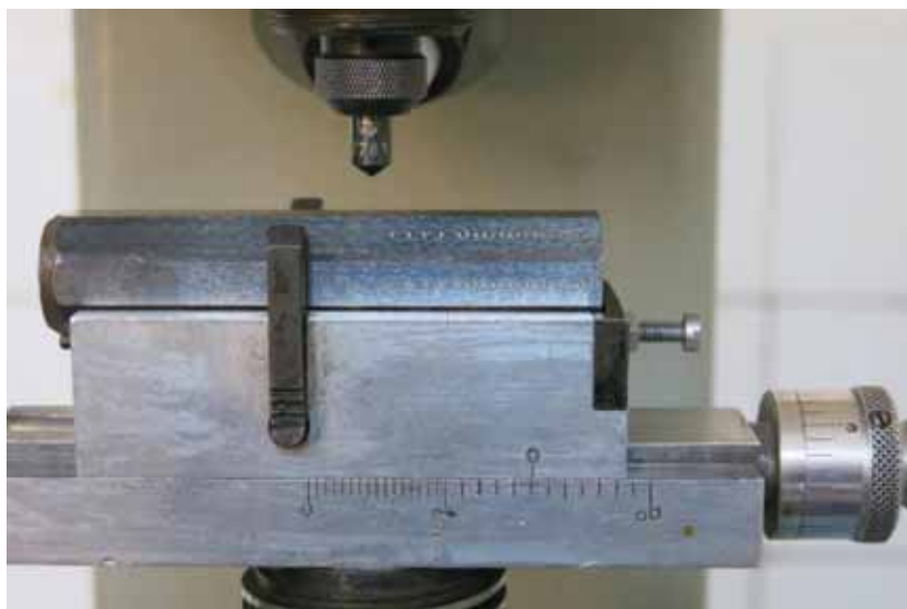
Obr. 3.8. Meranie tvrdosti pomocou prípravku
