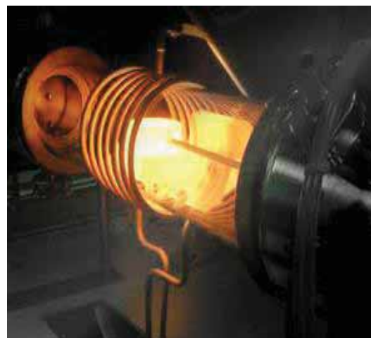
Obr. 2.23. Príklady indukčného vysokofrekvenčného povrchového kalenia
