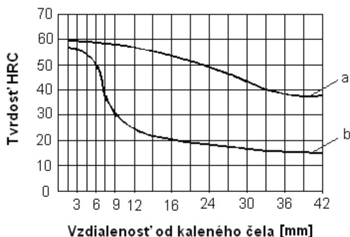
Obr. 3.10. Krivky prekaliteľnosti ocele a) s vysokou b) s nízkou prekaliteľnosťou
