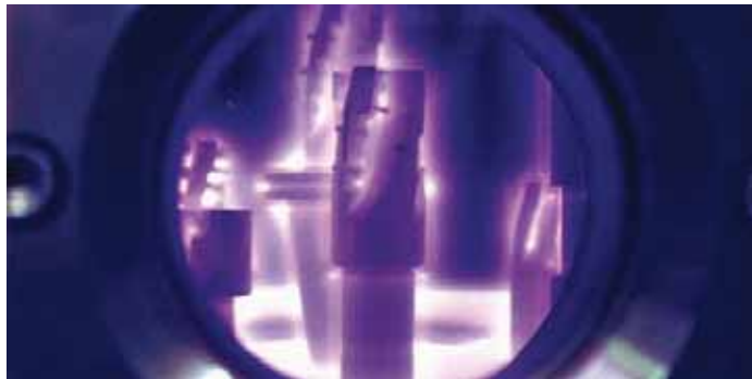
Obr. 4.3. Príklad nauhličovania súčiastok v plazme
