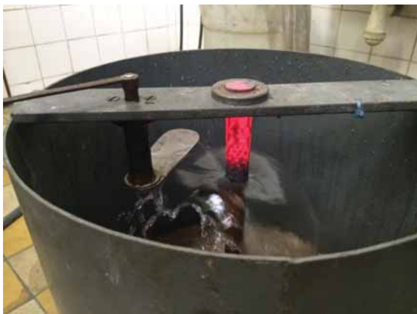
Obr. 3.7. Jominyho skúška prekaliteľnosti
