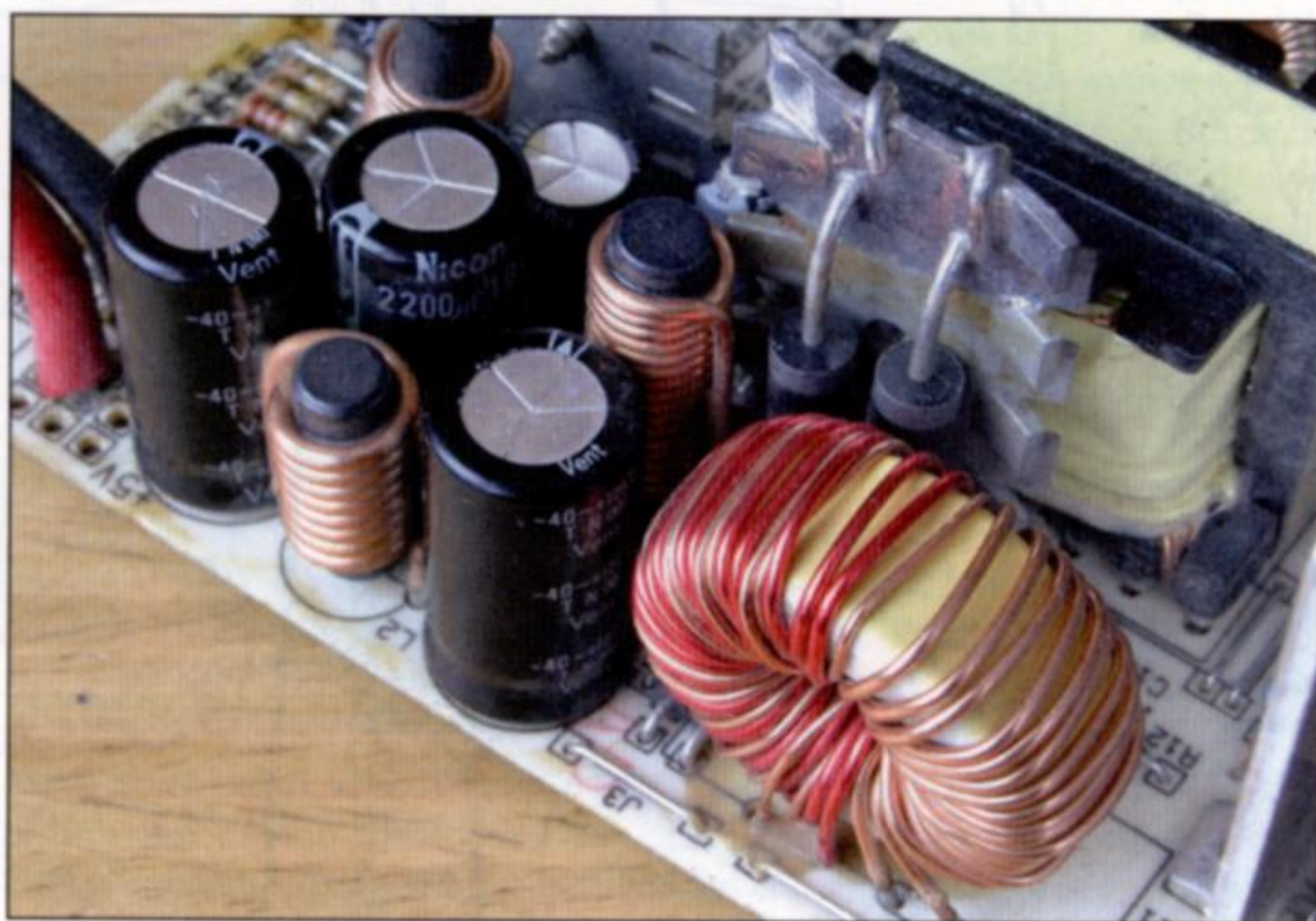
Oblast výstupních usměrňovačů a filtrů (původní svazek vodičů už byl odstraněn) – toroidní tlumivka v popředí je společná pro všechny větve.
