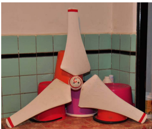
Obrázek 3.2-1: Sušení nově natřených listů při první údržbě v lednu 2012 (vlevo) a pohled na složený rotor (vpravo)
