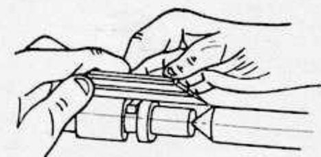
Obr. 219. Měření hloubky zápichu Johan-sonovou měrkou a vlasovým pravítkem.
