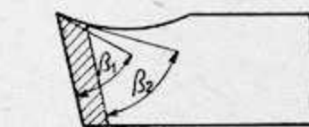
Obr. 15. Nůž s oblým čelem; úhel \beta při ostření roste.
