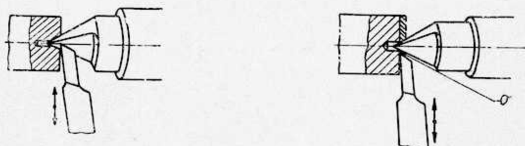
Obr. 140. Hrot sedí v kuželové části. Obr. 141. Hrot nesedí v kuželu důlku.
