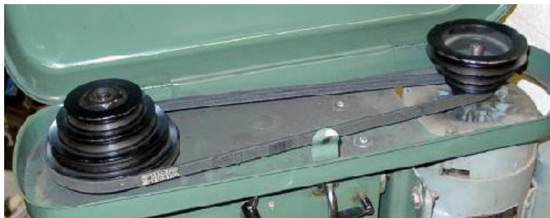
Obrázek 5.15 – Vřeteno s řemenovými převody - Pulleys
