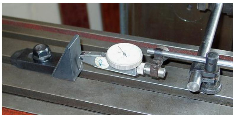
Obrázek 5.13 – Ustavení nulové polohy
