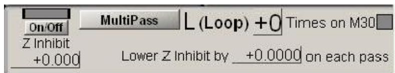
Obrázek 6.19 – Automatické řízení osy Z
