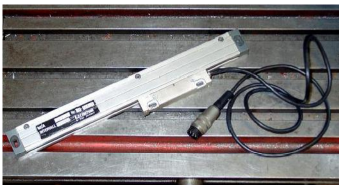
Obrázek 4.15 – Lineární enkoder připraven na montáž
