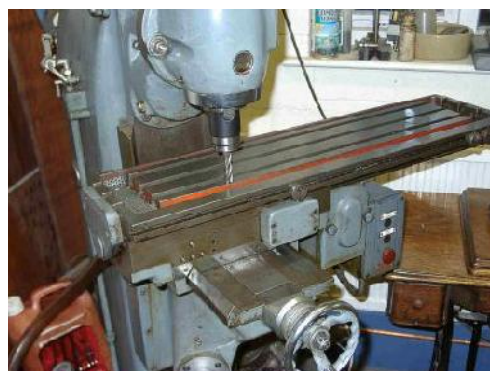
Obrázek 4.10 – Fréza s nástrojem v poloze X=0, Y=0
