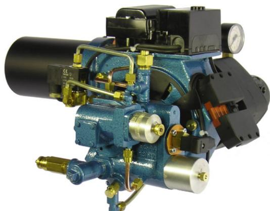
Der AR-CO Niederdruckbrenner ist weltweit für seine robuste Konstruktion bekannt. Der mechanische hochwertige Aufbau des Brenners (Kompressorrolle -schaufeln und -buchse) und der Zumespumpe (Rotor, Kolben, Ring) aus gehärtetem Spezialstahl sichern lange Laufzeiten und Betriebssicherheit. Jeder Brenner wird werkseitig am Feuer getestet, um somit Qualität und Zuverlässigkeit zu gewährleisten.
