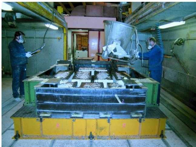
Obrázek 14: Odlévání do formy
