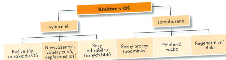
Obr. 5.18. Příčiny kmitání v obráběcích strojích [1]
