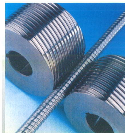
Obr. 5.81. Výroba profilu závitů šroubu válcováním [Rexroth]
