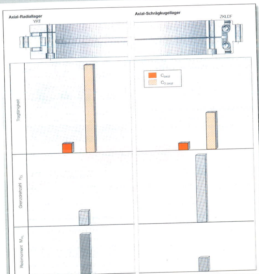
Obr. 5.157. Speciální ložiska pro ukládání desky stolu [INA]
