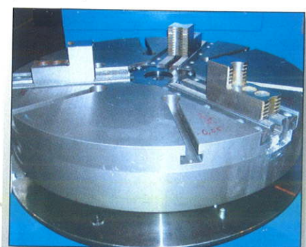
Obr. 6.27. Tříčelisťové sklídlo [TOSHULIN]
