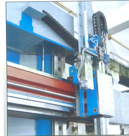
Obr. 6.31. Příčnick s příčnickovým suportem [TOSHULIN]
