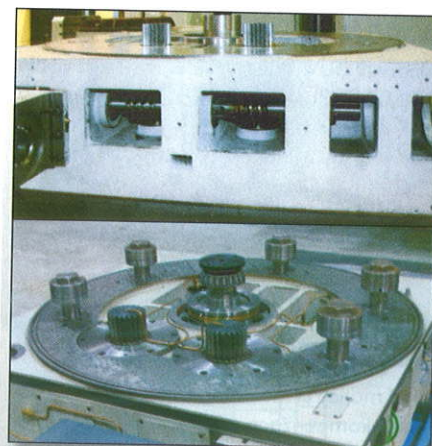
Obr. 8.10. Hydrodynamické vedení stolu stroje TK6511B [SMTCL]
