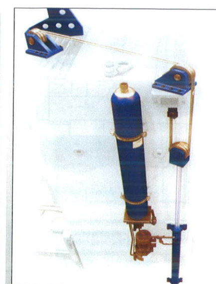
Obr. 8.17. Vyvažování vřeteníku TOStec [TOS Varnsdorf]
