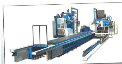
Obr. 9.11. Pohled na dvojici ložňových frézek FFQ [TOS Kuřim]
