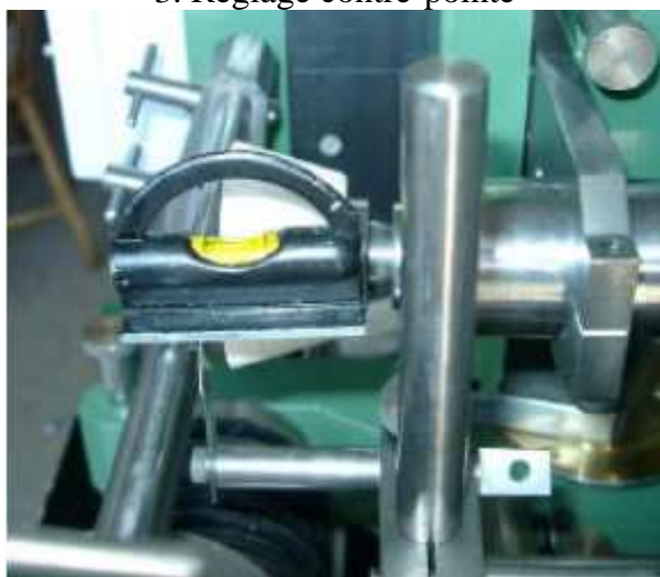
5. Vue montrant l'utilisation du niveau
