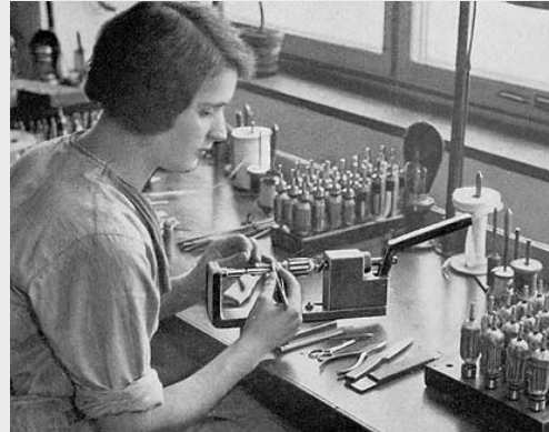
Der BOSCH-Hammer: Anschließen des Kollektors
