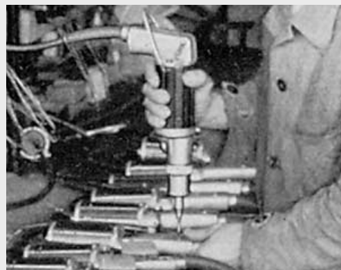
Der BOSCH-Hammer: Einschrauben des Schalters
