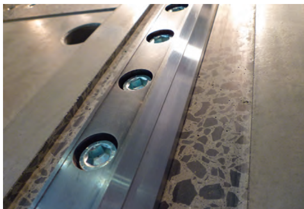
Obr. 5: Detail upevnění svislých vedení na stojanu TOSHULIN
