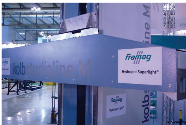
Obr. 8: Demonstrační těleso smykadla z materiálu Hydropol-Superlight a stojanu z materiálu Hydropol-Light
