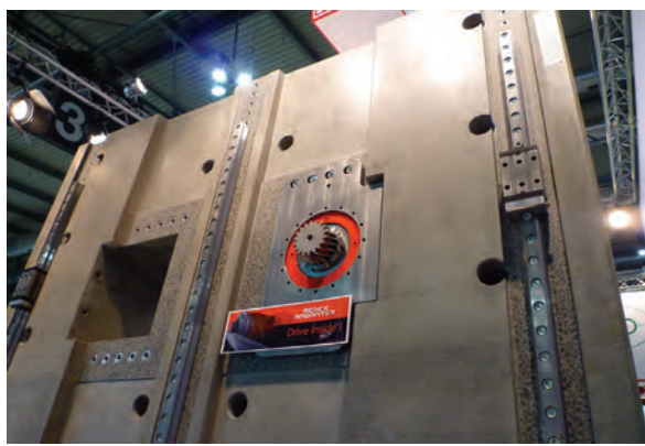
Obr. 4: Detail stojanu s uložením převodovky náhonu pastorku pro svislý posuv příčniku.
