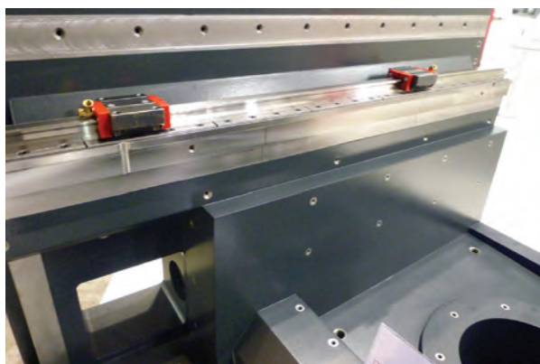
Obr. 15: Detail polmerbetonového odlitku s integrovanou ocelovou lištou pod lineární vedení a s osazenou kolejničí lineárního vedení.
