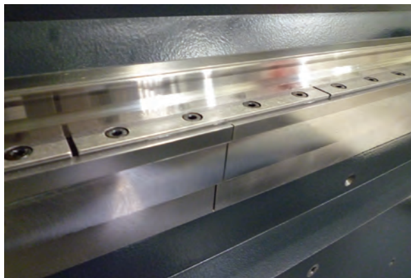
Obr. 16: detail dilatačních spár zalitého ocelového profilu, který je základem pro upevnění kolejnice lin. vedení. Řešení je vynucené rozdílnou teplotní roztažností a teplotně mechanickými vlastnostmi oceli a polymerbetonu.
