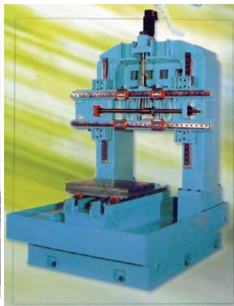
Obr. 34: Příklad jednoduchého středového pohonu příčnicku vertikálního centra.
