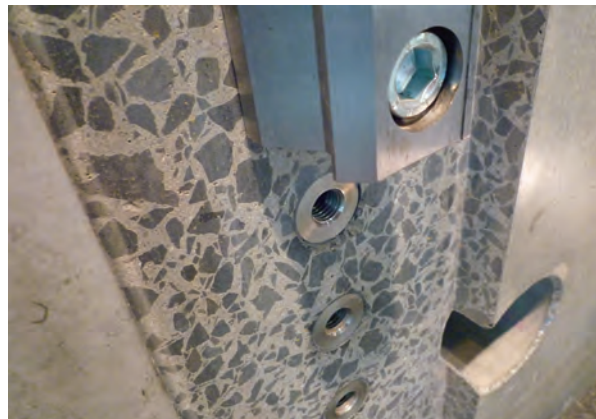
Obr. 6: Detail obrobené (broušené) plochy a vlepených ocelových závitových pouzder pod lineární vedení.
