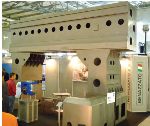
Obr. 24: Prezentovaná svařovaná nosná struktura portálu firmy Benazzato S.r.l.
