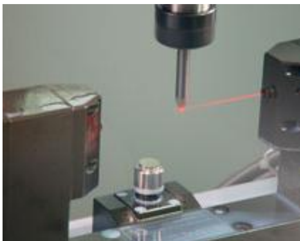
Obr. 3.4 Přerušení paprsku při měření nástroje. 26
