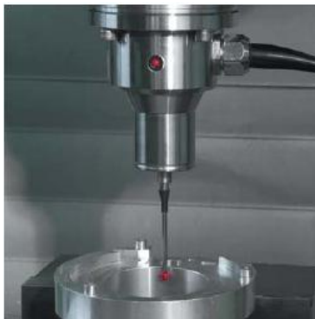
Obr. 2.15 Přenos kabelem Heidenhein. 13
