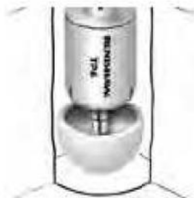
Obr. 2.11 Půlkulový dotek 16 a) použití půlkulového doteku b) katalogové schéma
