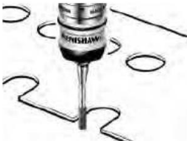
Obr. 2.9 Válcový dotek 16 a) použití válcového doteku b) katalogové schéma.
