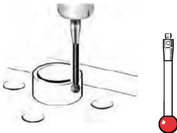
a) b) Obr. 2.6 Přímé sondy 16 a) použití přímé sondy, b) katalogové schéma.
