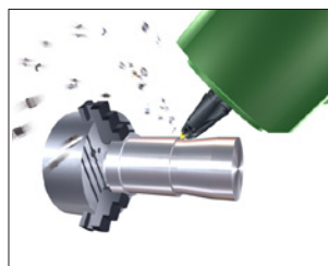
Stranové a tvarové soustružení s DNMG destičkou.
