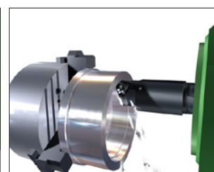
Použití zdvojeného nástroje pro 90° jako vyvrtávací tyče.
