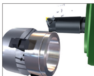
Soustružení s osou B nastavenou na 0°. Dobrá alternativa v případě, že má stroj omezený dosah v ose X.
