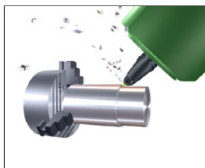
Stranové a čelní soustružení s CNMG destičkou.
