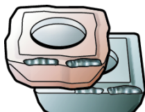
Opotřebení ve tvaru žlábků
