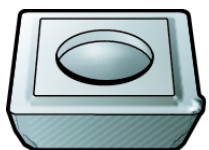
Plastická deformace (obvodová břitová destička)
