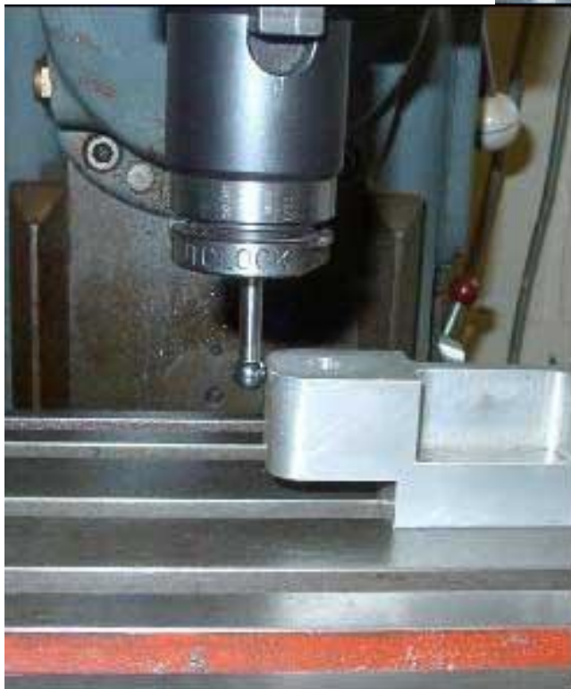
7.11. Obrázok. Zameranie kontúry v osi X
