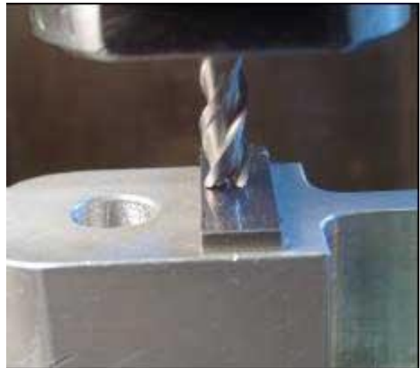
7.6. Obrázok – Čelna freza
