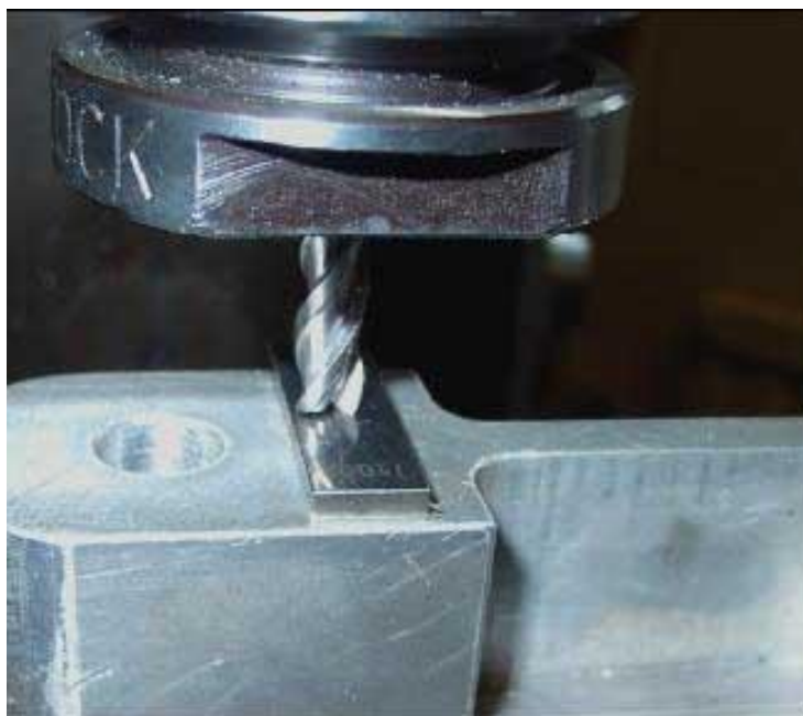
7.10. Obrázok. Posun osi Z stanovaný pomocou merítka
